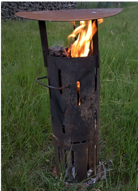
Abbildung 2: Ofen zur Frostbeheizung mit biogenen Brennstoffen
