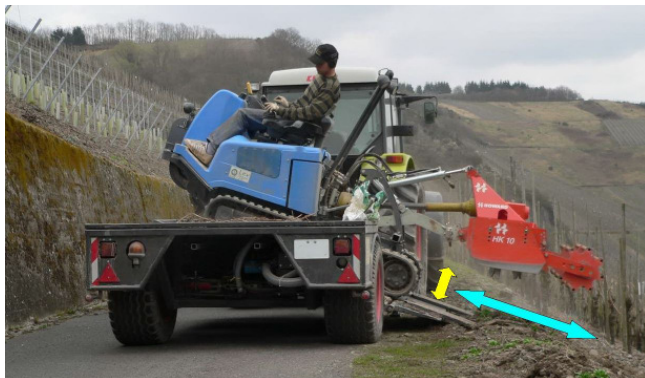
Abb. 1: Das RMS besteht aus Raupe mit Hangelwinde, Anhänger mit Kipppritsche und Zugschlepper mit Fernfahreinrichtung
