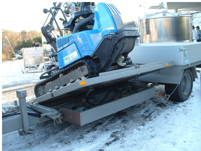
Abb. 5: Bender RMS-Anhänger mit Kipppritsche, Transportplattform und Bordwänden
