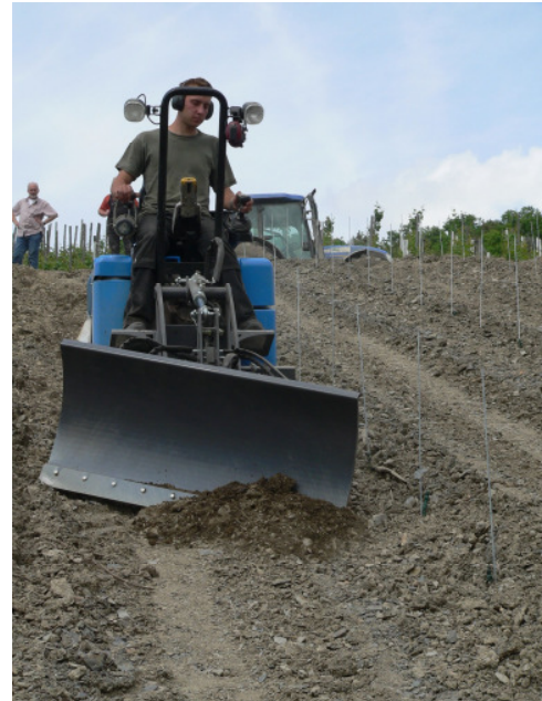
Abb. 14: Planierschild zur Terrassierung von Rebgassen mit Steilhang
