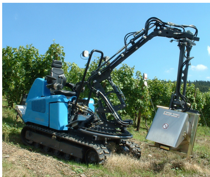
Abbildung 9: Geiertraupe mit Multifunktionsarm und Entlaubungsgerät
